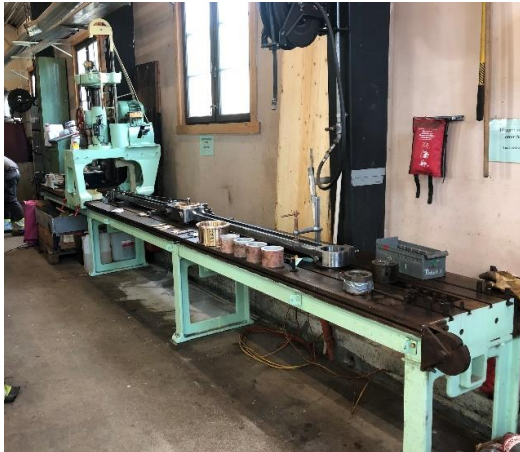
Stangbenken har tidligere blitt overhålt med tanke på utboring av lagrene i koblestengene. I 2021 har det blitt lagt mye arbeid i å fremstille oppspanningsverktøy. Forrest sees tre nystøpte lagre. Foto Henrik B. Backer
