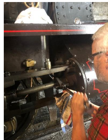
Utbedring av stempelstangpakning 2.8.2021.
