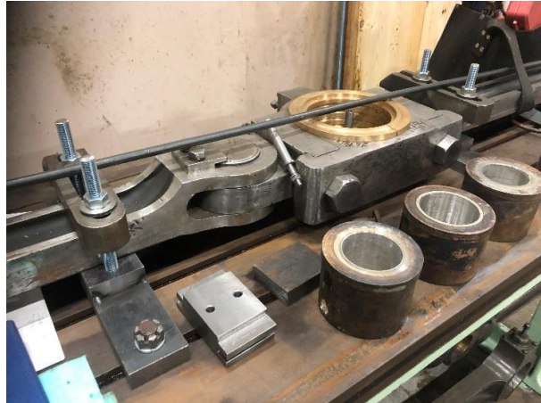
Stangbenken har tidligere blitt overhålt med tanke på utboring av lagrene i koblestengene. I 2021 har det blitt lagt mye arbeid i å fremstille oppspanningsverktøy. Forrest sees tre nystøpte lagre. Foto Henrik B. Backer
