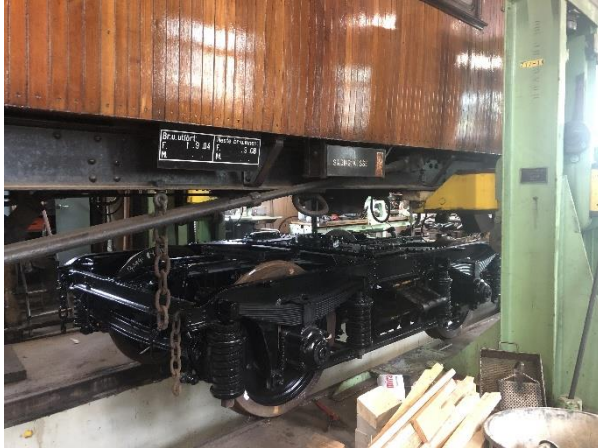
Nyoverhalt boggi under CFo 213. Jørgen Nøkleby og Eirik Håland justerer senterpannen på bolstret. Foto Henrik B. Backer
