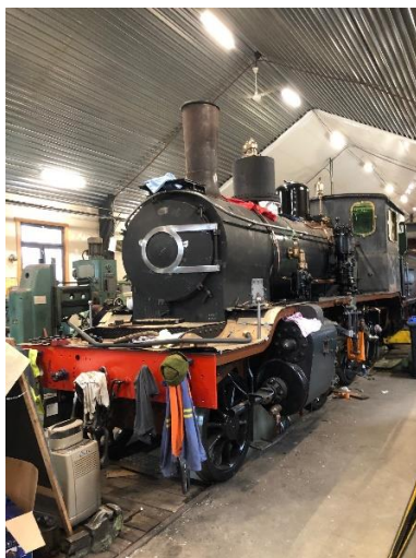
Loket i november etter at skorsteinen var montert på plass
