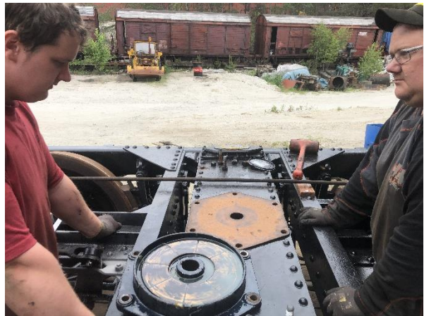
Nyoverhalt boggi under CFo 213. Jørgen Nøkleby og Eirik Håland justerer senterpannen på bolstret. Foto Henrik B. Backer
