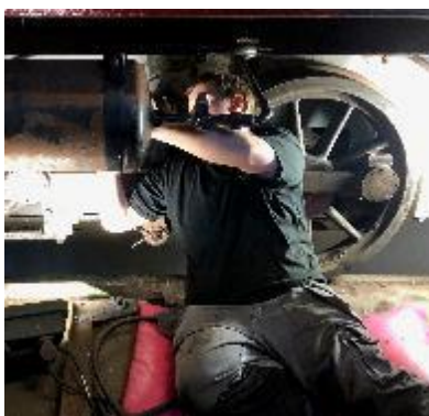
Jørgen R. Nøkleby demonterer trykkluftbeholder. Denne ble senere tromlet, oljet og trykktestet Foto: Henrik B. Backer
