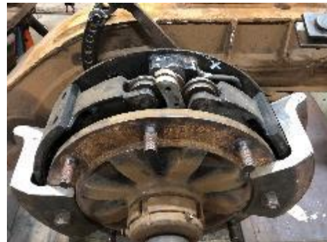
Bremsebakkene virker på innsiden av hjulene. Nye deler til bevegelsen av disse måtte lages nye for å få bremsene til å ta jevnt. For å få dette helt nøyaktig måtte et utrangert hjul splittes og festes på plass Foto: Henrik B. Backer
