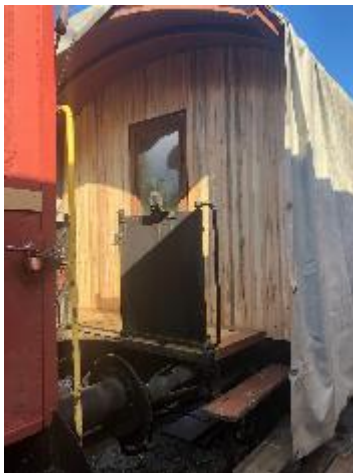
Endevegg med nytt panel Foto: Henrik B. Backer
