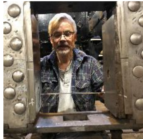
Odd Arne Lyngstad måler etter sliping – 0,06 mm avvik er innenfor! Foto: Henrik B. Backer
