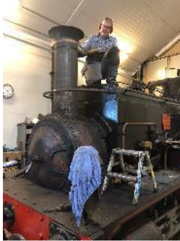
Kristian Nøkleby sliper vekk gammel maling fra pipe og røykskap Foto: Henrik B. Backer
