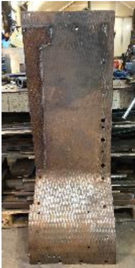
Fotbrett med nødvendig reparasjon. Foto: Henrik B. Backer
