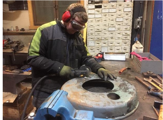
Jørgen Nøkleby sliper en sveist sprekk i deksel sylinderfront til damplok 225.
