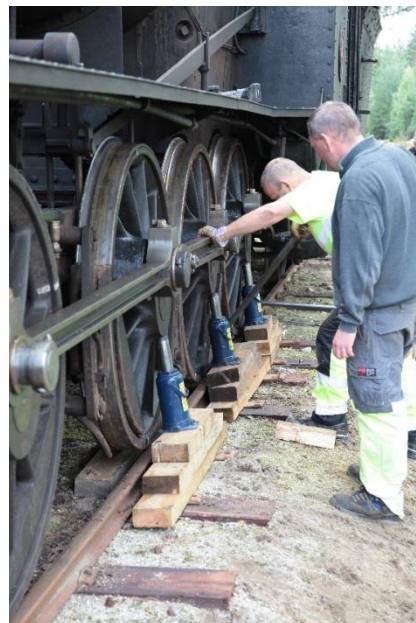
Oppjekking av 1122 etter avsporingen 8/8-2016. Foto: Helge Lindholm
