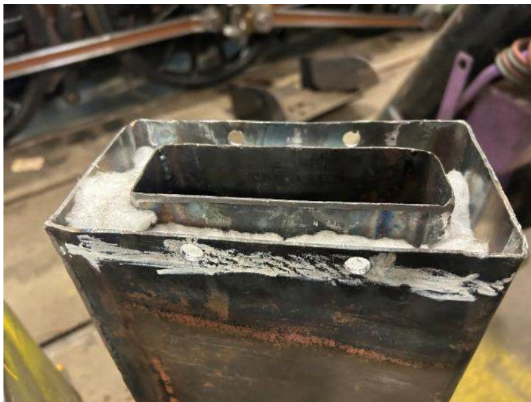
Røykrøret fra Schweizerapparatet er et firkantet rør-i-rør med isolasjon som er ført gjennom en ventilt og beslått kanal i deleveggen mellom to kupeer. Til høyre sees overgangen til røret mot pipehatten på taket. Foto Henrik B. Backer
