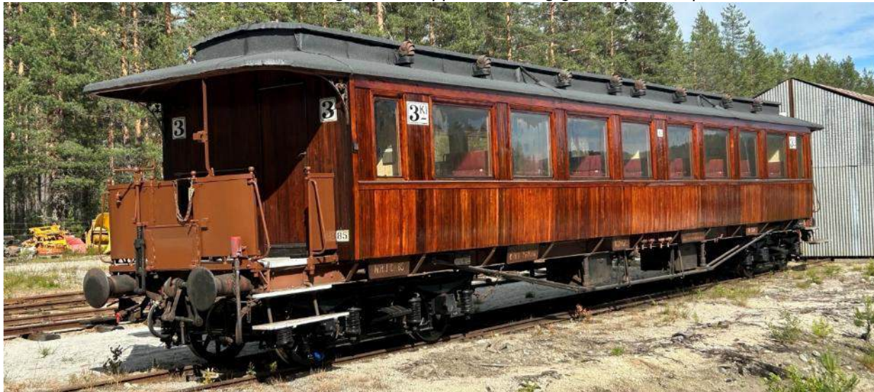
Co 85 med nyoljet vognkasse, nymalte plattformrekkverk og nyoverholte boggier. Foto Henrik B. Backer
