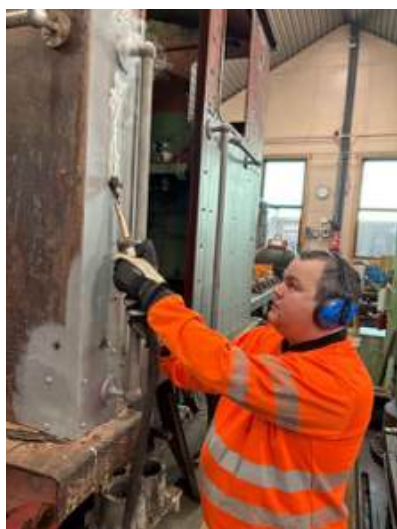
Jim Hagen Warp bruker induksjonsvarmer for å løsne fastrustne bolter på førerhytta. Foto: Pål Stian Wahlquist
