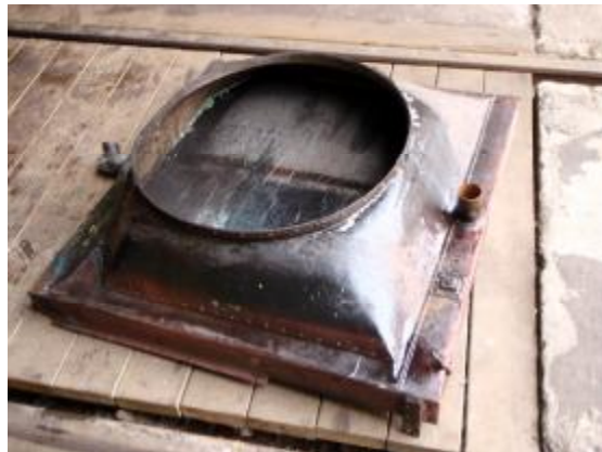
Den demonterte radiatoren.
