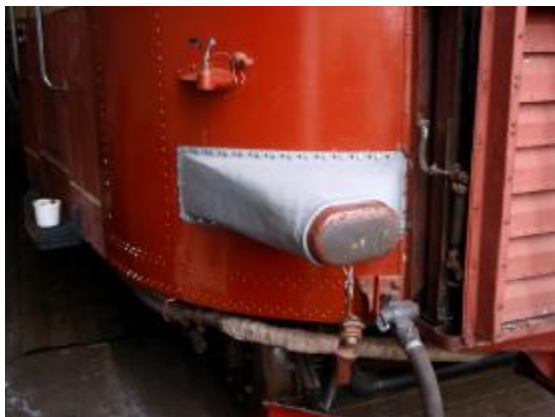
Den nymonterte høyre buffer.
