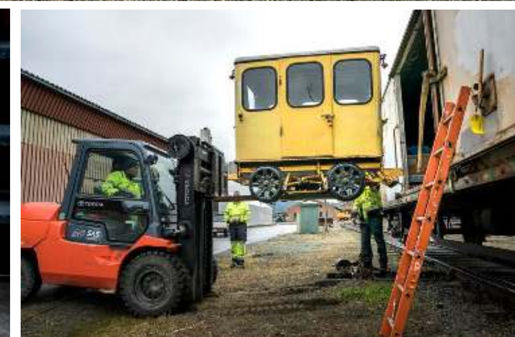
Arbeidsvogn: Den vesle gule arbeidsvognen er en Fairmont MT14-M Speeder motortralle, som er en slags overbygd dresin. Vognen har en tosylindret bensinmotor som yter 20 hestekrefter.
